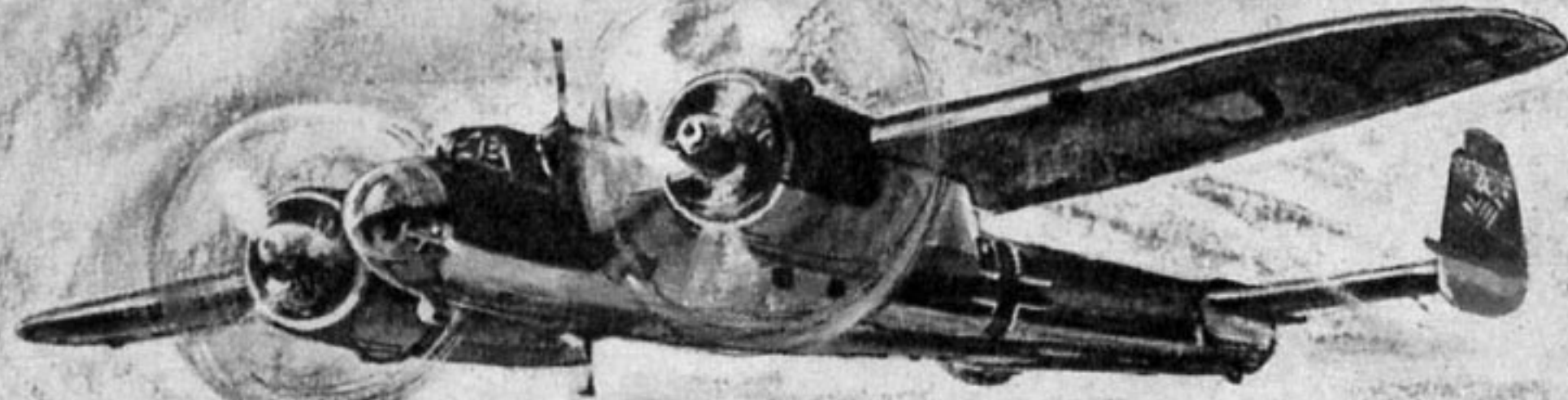
Do 17 Mehrzweckflugzeug (Kampfflugzeug oder Fernaufklärer), zweimotorig, Besatzung 3 Mann. Je 1 MG im Rumpfbug und auf Rumpfoberseite, 1 Boden-MG, Bombenlast 1000 kg. Höchstgeschwindigkeit bis 500 km/h (je nach den verwendeten Motoren verschieden), Landegeschwindigkeit 110 km/h, Dienst- gipfelhöhe 9000 m, Reichweite 2500 km
