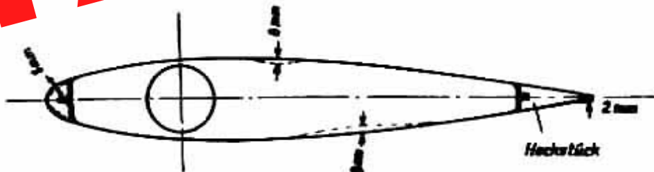
Abb. 4: Zulässige Beschädigungen am Flügel
